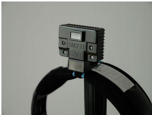
Links: Am Kopfhörer befestigter Headtracking-Sender (16),
