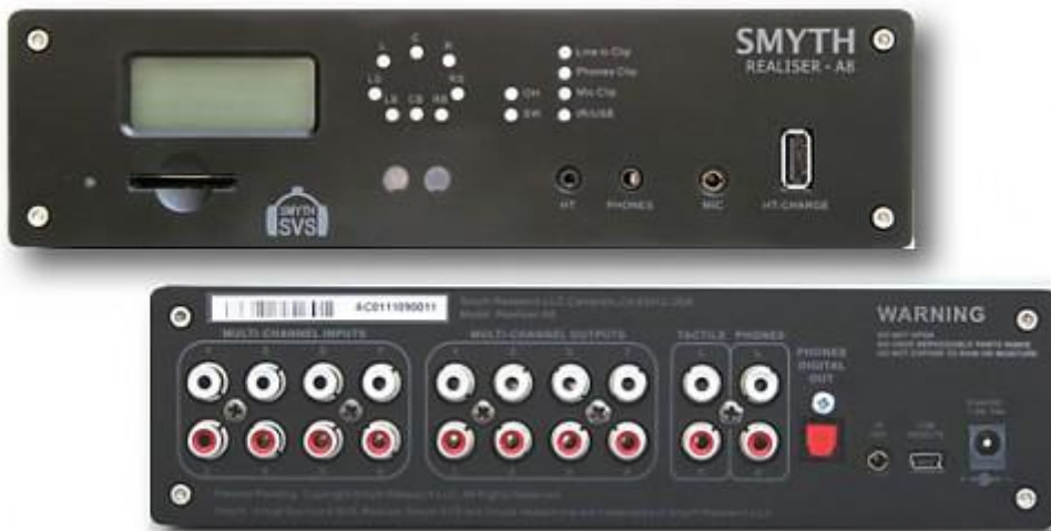
Der Smyth Research SVS Realiser A-8, oben: Vorderseite, unten: Hinterseite mit Cinch-Eingängen und –Ausgängen (13)
